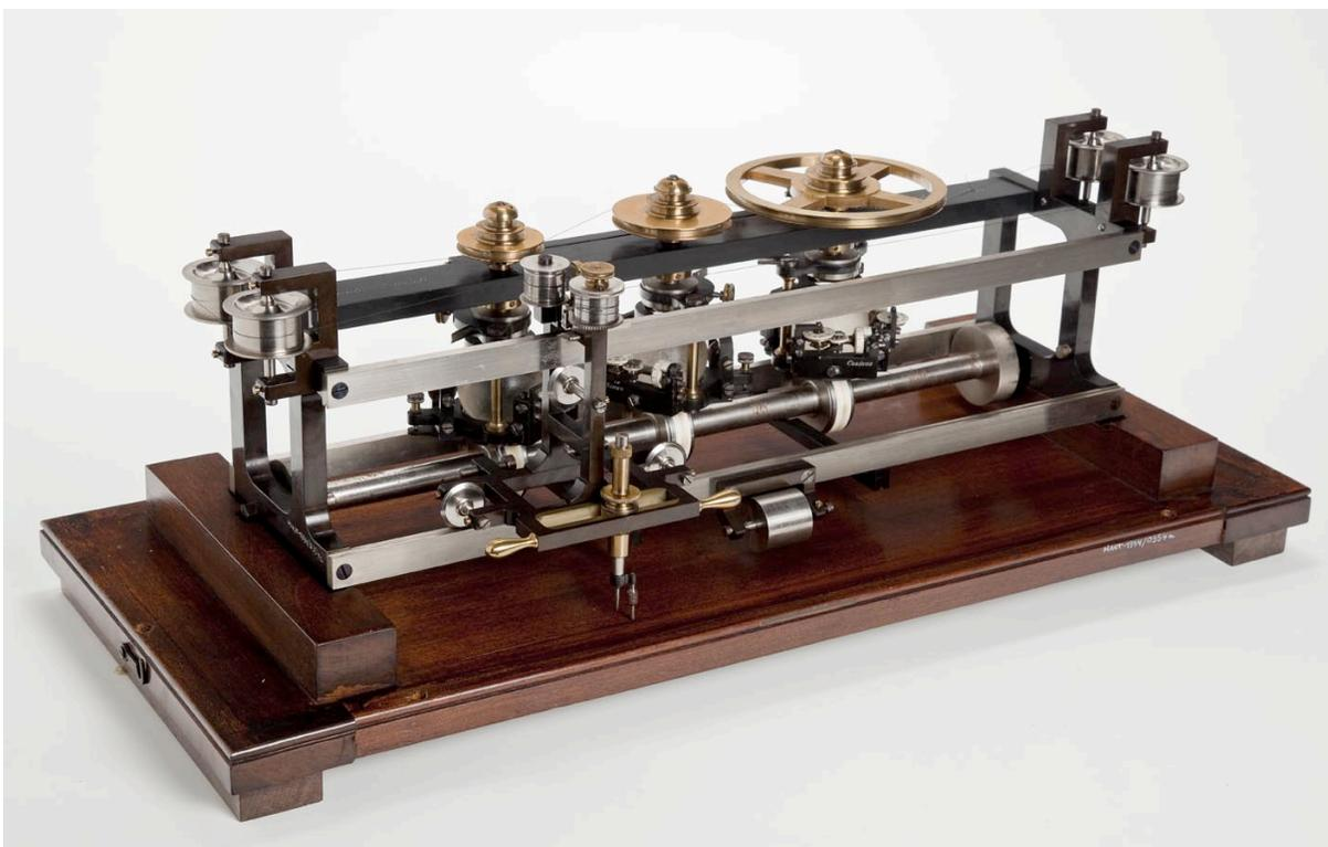
**Figura 1-** Analisador harmônico (Acervo MAST)
