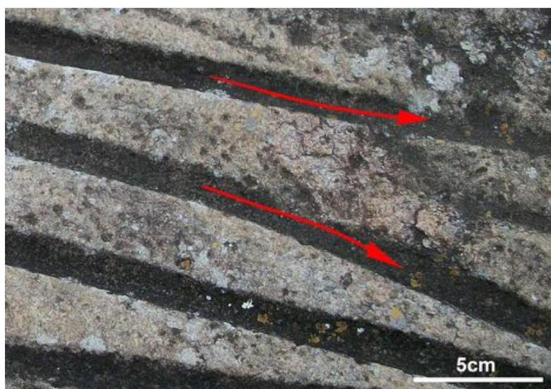
Figura 28 - Desvio de sulcos de perfuração ao redor de concentrado de grãos de feldspatos.
