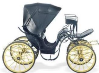
Figura 5 – Victoria com banco do cocheiro encaixado. Dimensões: 270x140x195cm.<sup>34</sup>
